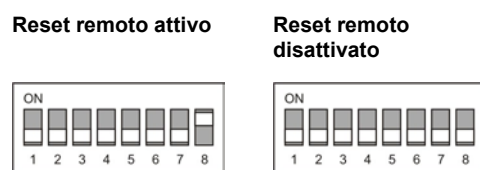
Figura 23: Configurazione del comando reset remoto
