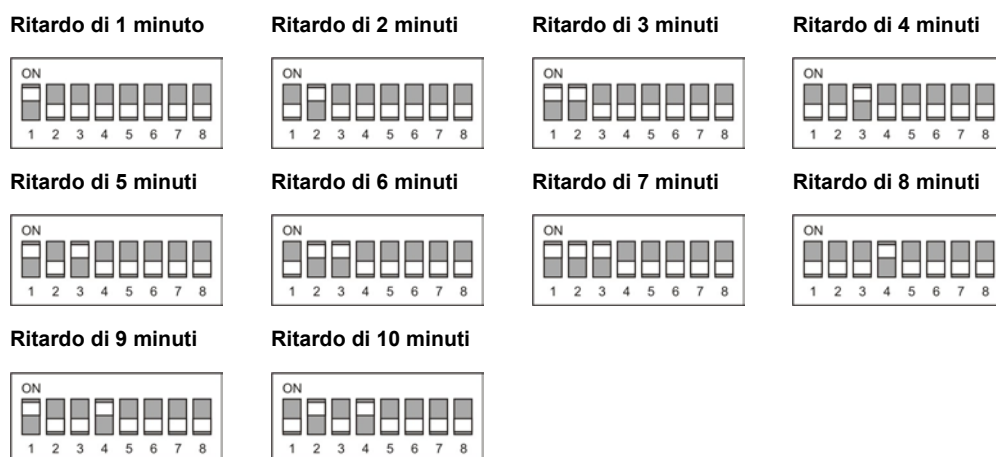
Figura 19: Impostazioni del DIP switch per il ritardo delle sirene
